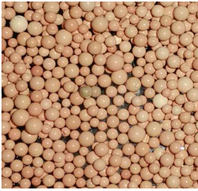
2 万 m 3 /h 的流化床吸附浓缩-催化燃烧装置适用于流化床的高耐磨性能球形吸附剂
