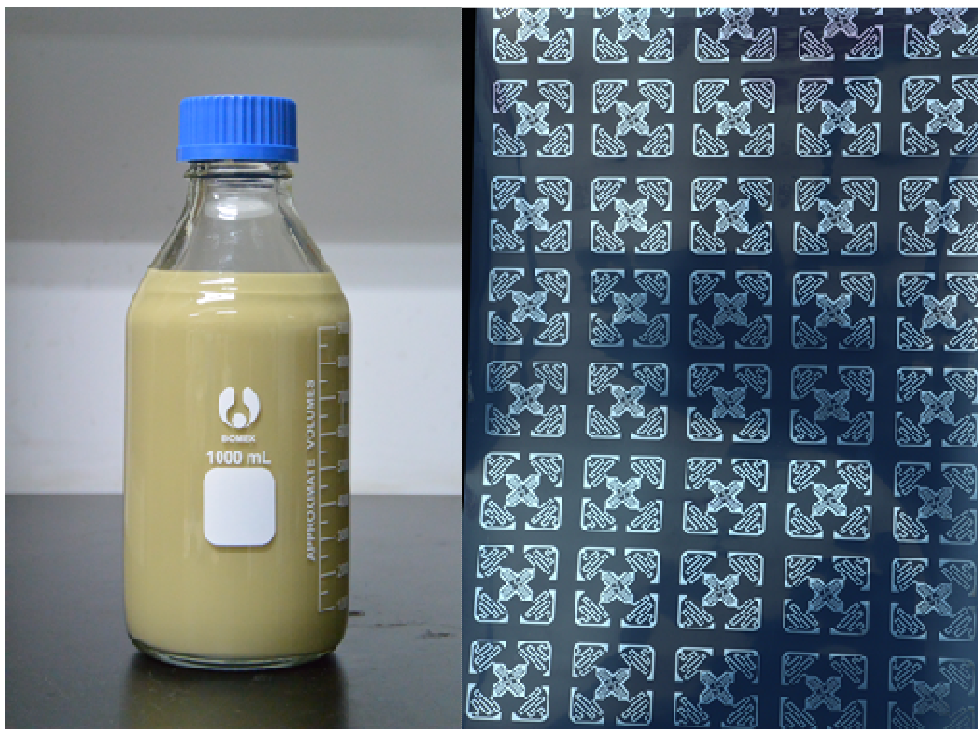
图 2 纳米导电墨水（左，可用于柔印、凹印及喷墨打印工艺）和绿色印刷 RFID 天线（右）
