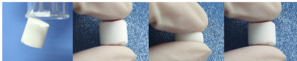
图 2 桥联倍半硅氧烷气凝胶可压缩性。
