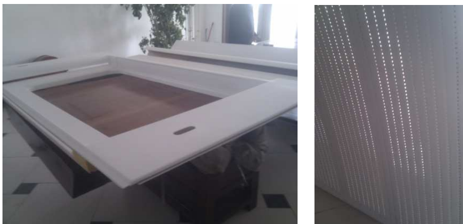
某型列车用内饰板如下图所示，左图为蜂窝夹层结构，右图为层合板。
