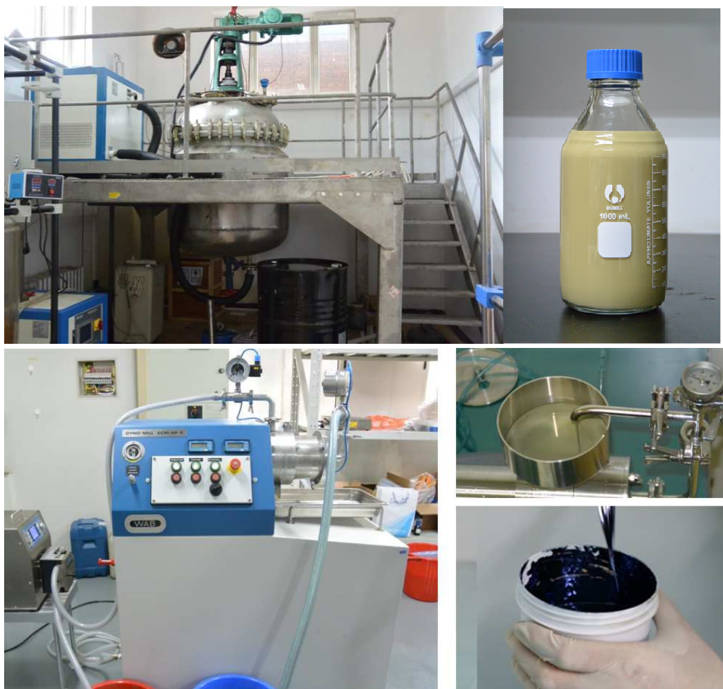
▲ 完成印刷 RFID 关键材料导电墨水中试生产
