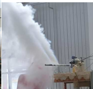
图 2 液氨管道泄漏实验
