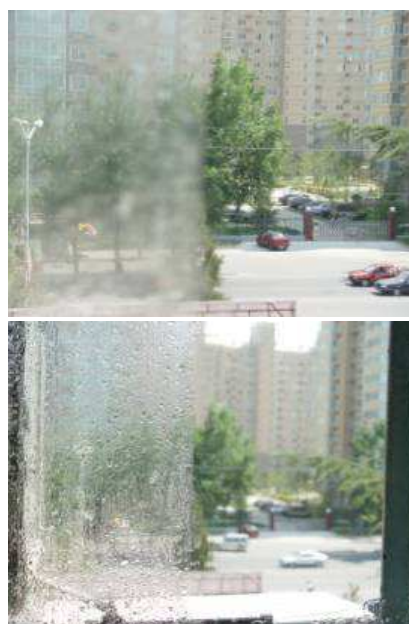
涂料在玻璃窗上涂膜一年后效果：上图：自清洁效果；下图：防雾效果（每块玻璃的左半边未涂膜；右半边涂膜）。
