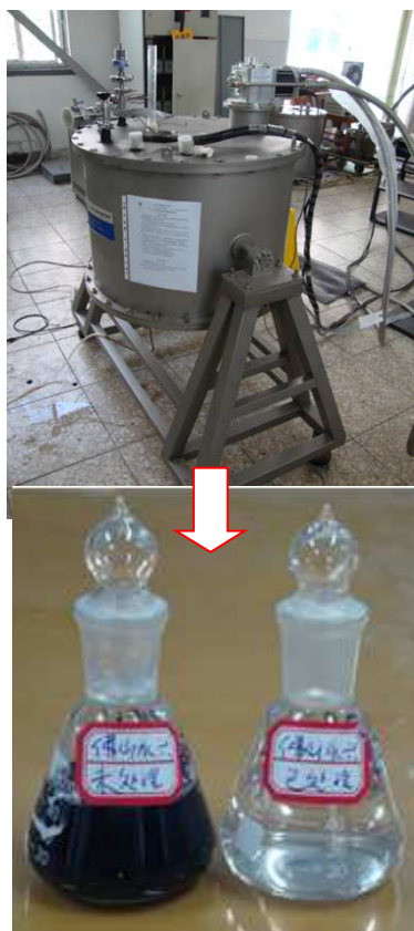
用超导磁分离污水处理系统处理前后水样对比
