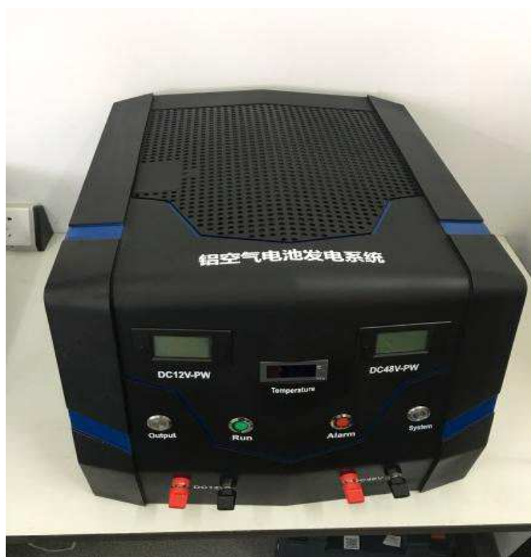
输出功率 1000W 的铝空气电池发电系统样机
