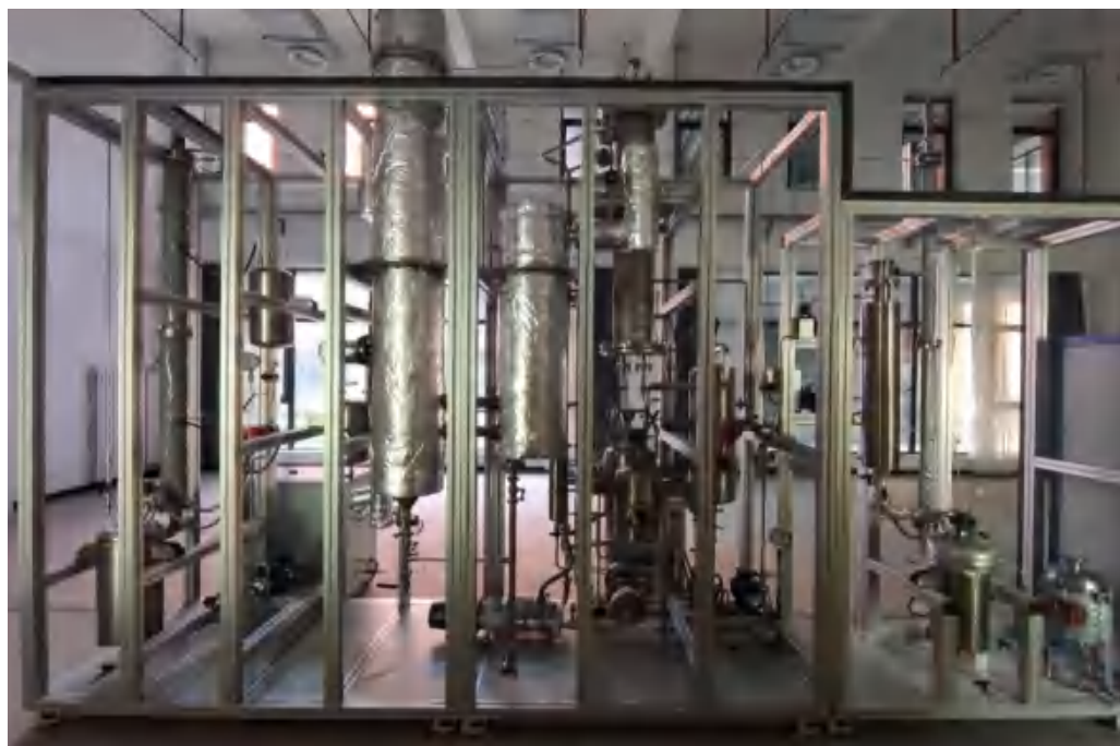
图 1 1 \text{ Nm}^3/\text{h} 离子液体法含氯 VOCs 吸收降膜解吸连续评价装置
