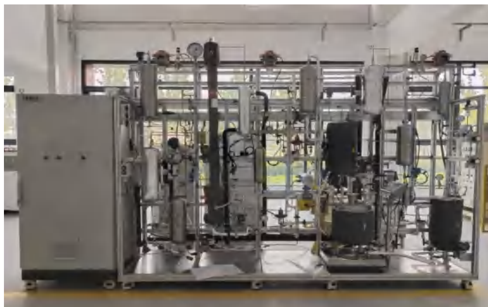
图 1 离子液体法循环气高压氨回收低碳工艺
