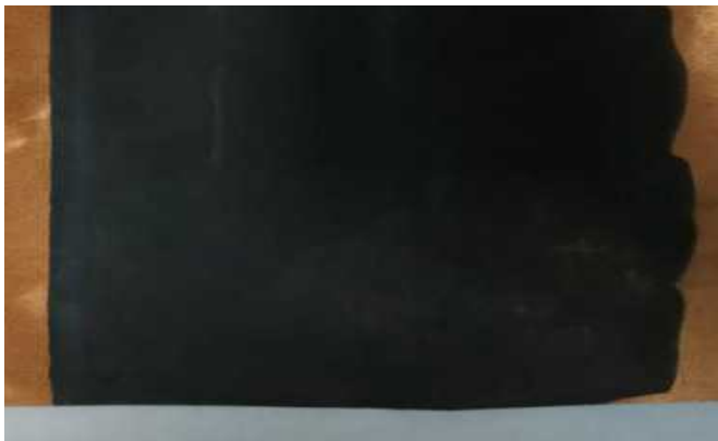
水性石墨烯基高分子聚合物浆料涂覆于镀铜导电布
