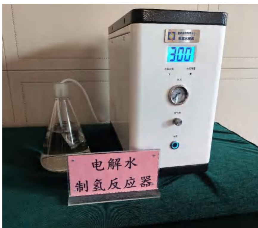
图 1. 非贵金属纳米电极用于分布式千瓦级电解水制氢设备。
