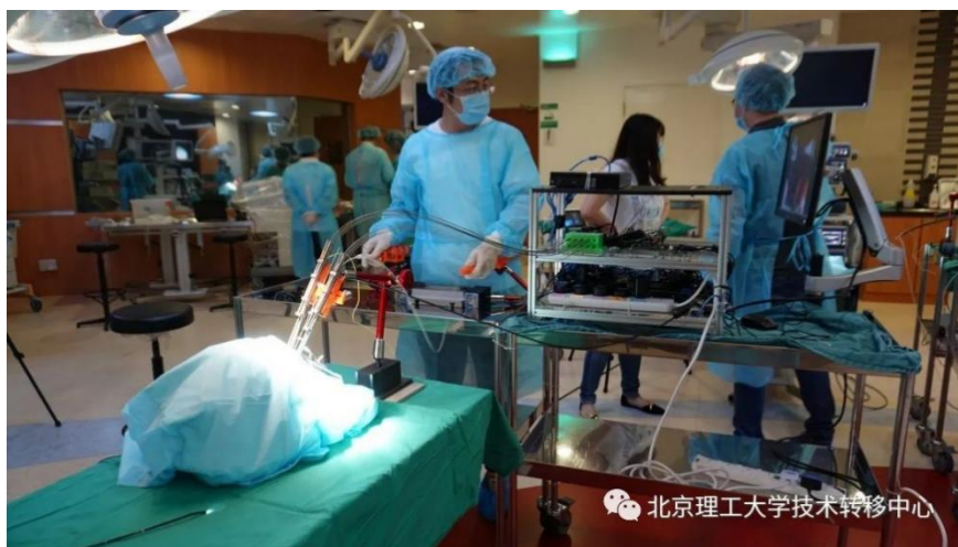
图 1. 基于刚柔耦合机构的喉部手术机器人尸体实验
