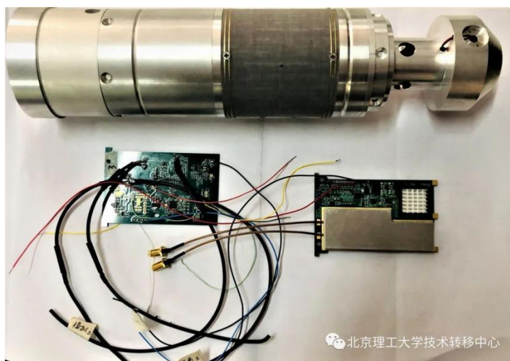
图 1. 气/固/液混合多相流流型/流量精准检测微系统原理样机
