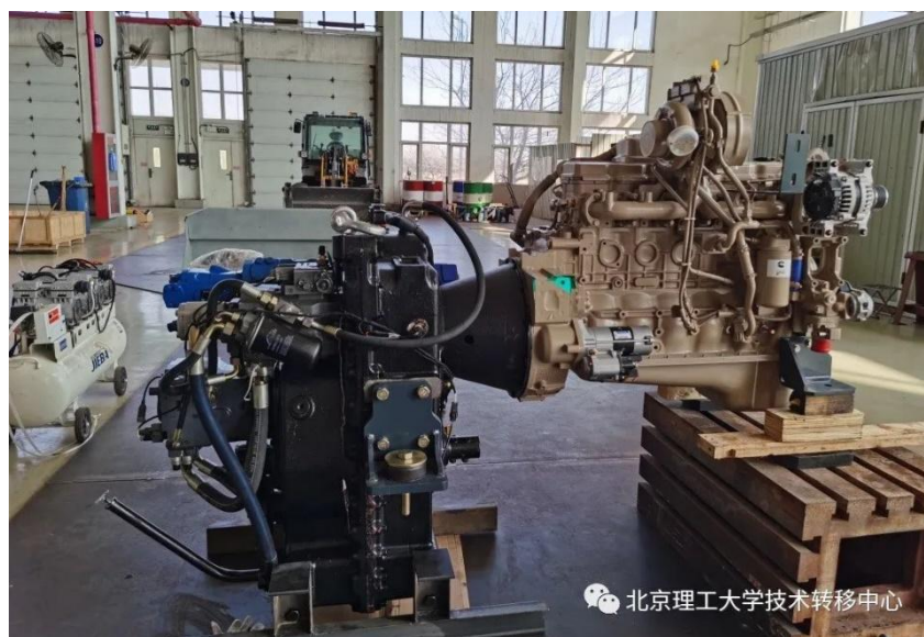
图 1. 装备本成果的工程机械动力总成
