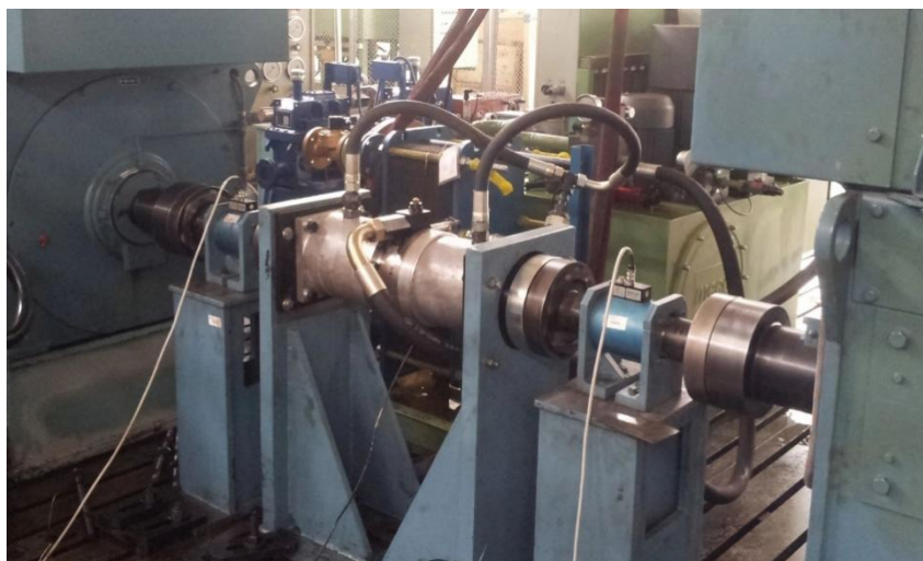
图 2. 背对背 285 排量泵马达试验
