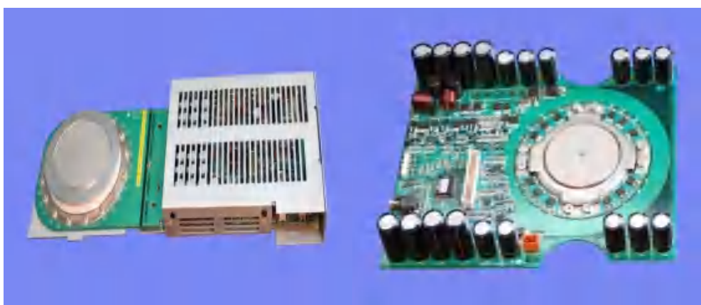
自主开发的 4000A/4500V 不对称型和 1100A/4500V 逆导型 IGCT 器件集成门极驱动单元
