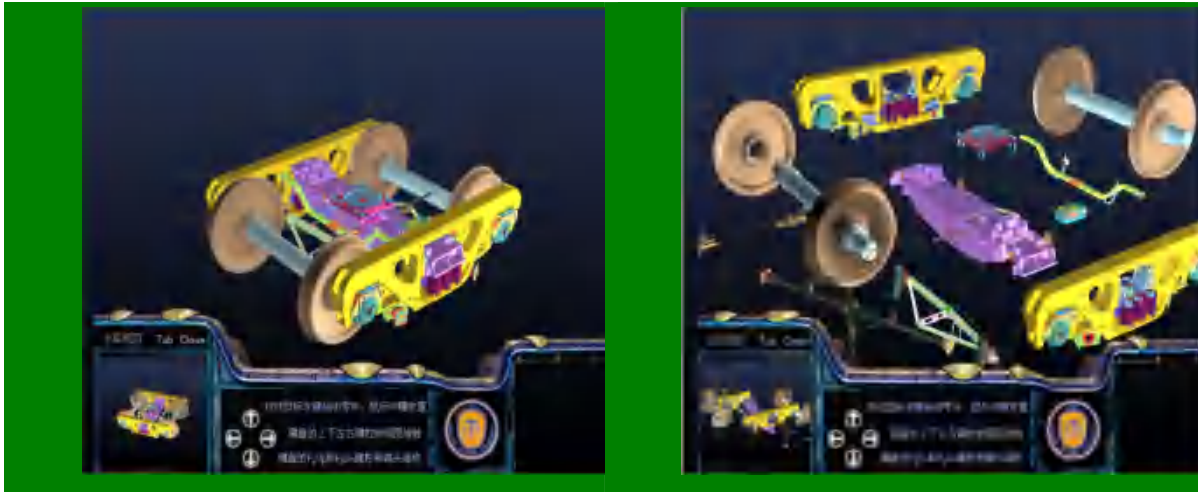
K6 转向架动态拆装系统（可进行 360 度旋转、缩放以及手动人机交互拆装）
