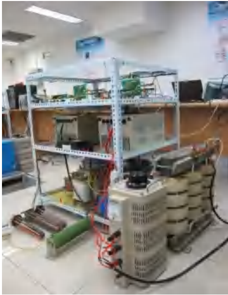
(a) 车载超级电容储能系统实验平台 (b) 地面超级电容储能系统实验平台
