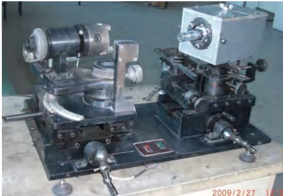
自主研发大孔径人造金刚石钢管拉拔模具卧式超声波加工机床
