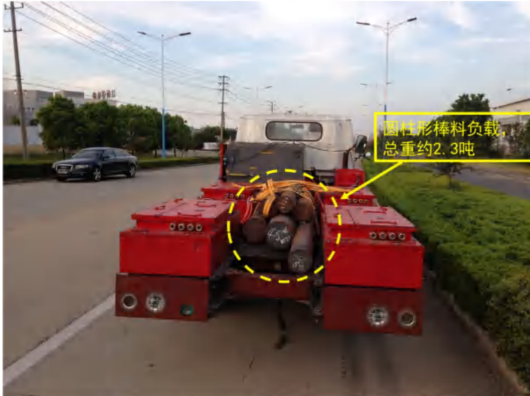
样车道路试验-装配负载
