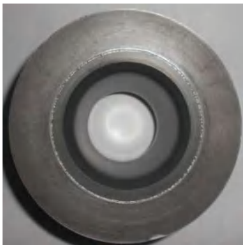
直径为 \phi 22.911\text{mm} 的大孔径人造金刚石管材拉拔模具
