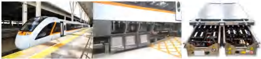
“复兴号”高速动车组及其锂离子电池储能系统
