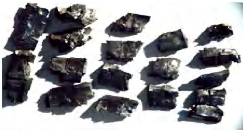
中碳贝氏体钢制造的预制破片炮弹打靶（厚铝板）及破片
